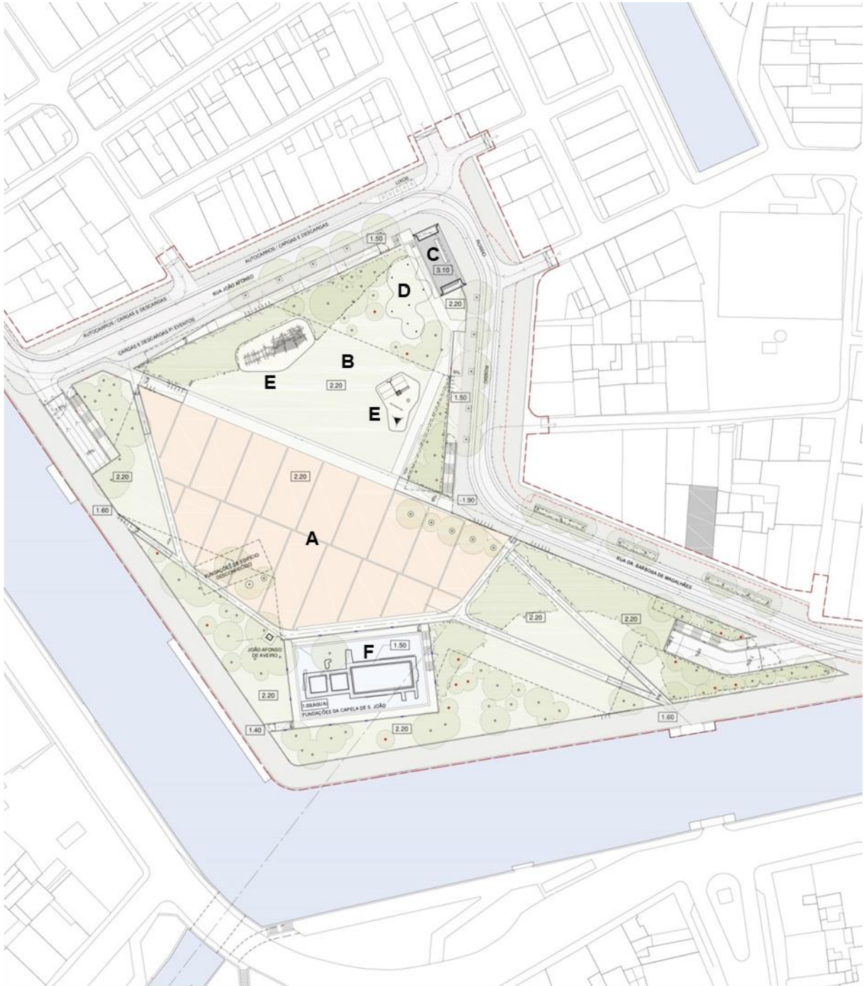
A. TERREIRO MULTIFUNCIÓNAL; B. JARDIM; C. BAR; D. ESPLANADA; E. PARQUE INFANTIL; F. CAPELA DE SÃO JOÃO DO ROSSIO
